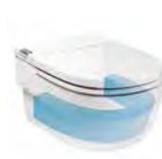
El primer inodoro que no necesita la instalación de una cisterna porque el depósito de agua está integrado en la propia taza. Un sistema de inyección de aire empuja el agua del depósito hacia la parte superior de la taza, proporcionando una descarga altamente efectiva y silenciosa.
